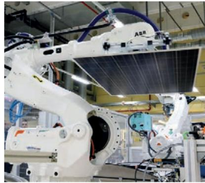
Astronergy produziert in Frankfurt (Oder) mit modernster Robotertechnik und 210 Mitarbeitern aktuell etwa 750.000 kristalline Solarmodule pro Jahr. Das entspricht einer Gesamtleistung von 180 MW.
