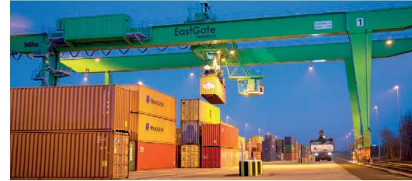
Eine gigantische und leistungsfähige Anlage: Mit der neuen Kranbahn am KV-Terminal Frankfurt (Oder) können die Containerumschläge deutlich beschleunigt werden. Die vom österreichischen Containerkranhersteller KUNZ AG gebaute und installierte Kranbahn kann bis zu 41 Tonnen gleisübergreifend über den 640 Meter langen Umschlagplatz bewegen.
