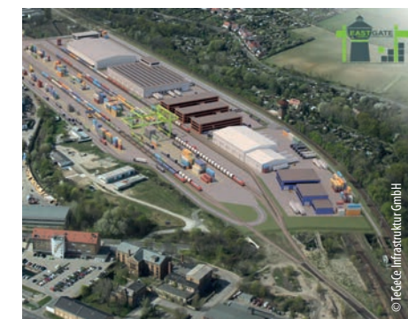
So wird es zukünftig am KV-Terminal Frankfurt (Oder) aussehen: Neben dem Bau zusätzlicher Gleisanlagen und der Installation einer gleisübergreifenden Kranbahn, werden derzeit neue Flächen für die Ansiedlung schienenaffiner Logistikunternehmen geschaffen.
